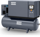
LZ: Einstufiger, ölfrei verdichtender Kolbenkompressor mit elektropneumatischer oder Elektronikon® MK5-Steuerung, schallgedämpft, mit einem maximalen Betriebsdruck von 10 bar (145 psi).
