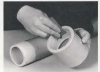
Fitting und Rohr abschleifen
